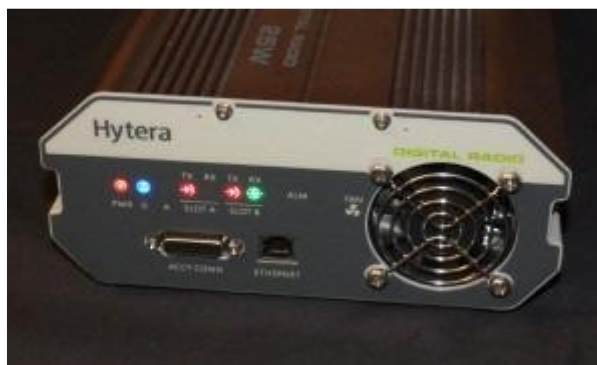
Fot. 1.10.2. Przemiennek „Hytera” RD625. Do wyjścia w eter potrzebny jest duplexer
