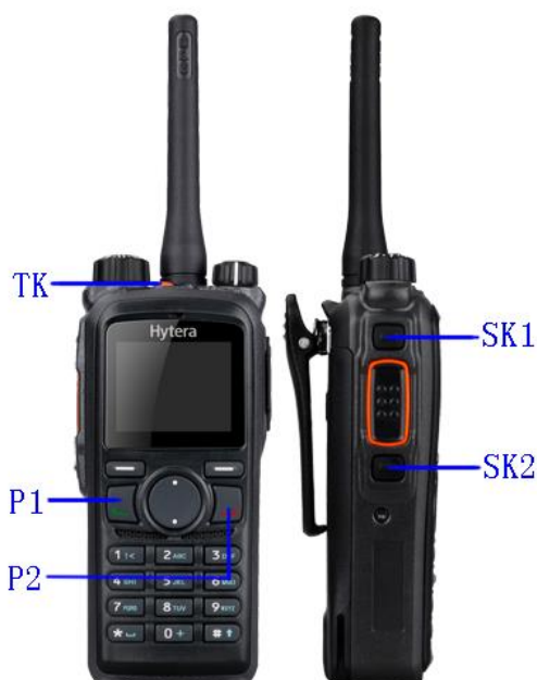
Rys. 4.2.8. Rozmieszczenie klawiszy programowalnych na obudowie PD-785(G). Ilustracja po lewej stronie jest wywoływana za pomocą przycisku „Button Preview”
